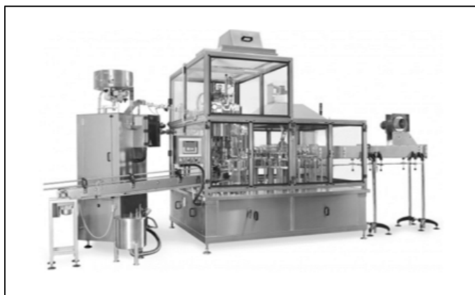
تصویر شماره ۱۵- دستگاه تری بلوک
